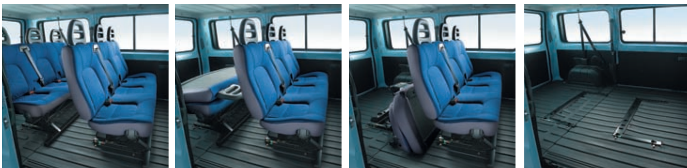
Сиденья пассажирского салона можно сложить или вообще убрать, что позволит увеличить объем грузового отсека в 4 раза.
